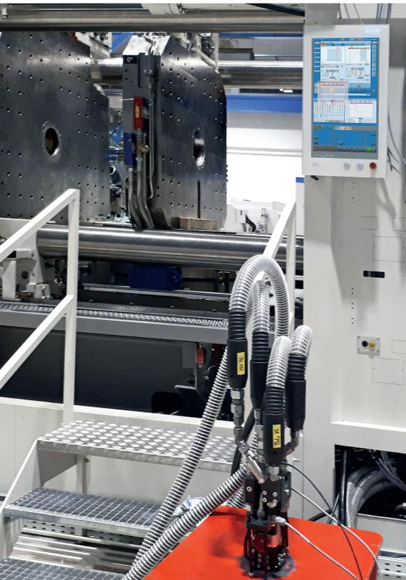
**Bild 2.** Das Spritzgießwerkzeug mit Wendepfad für die Produktion des Thermoplastträgers macht die MXW 1000 von KraussMaffei besonders produktiv. © KraussMaffei
